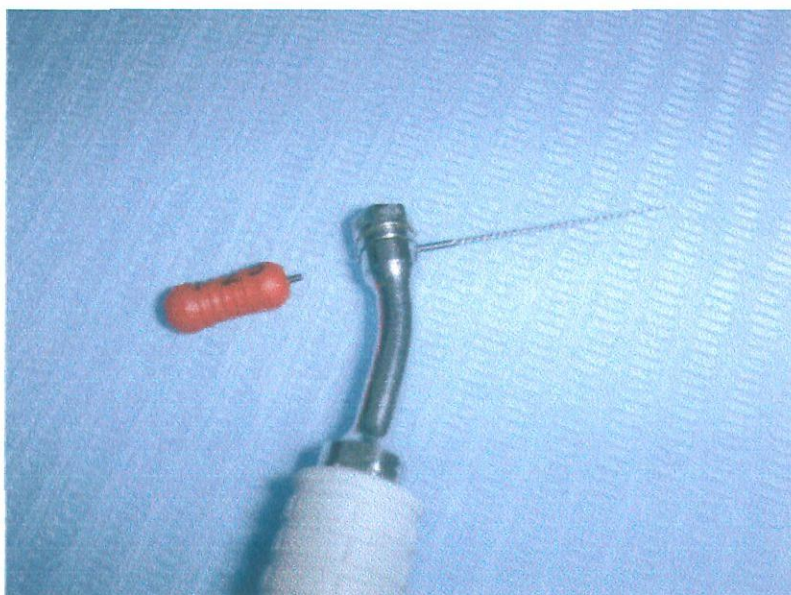
FIGURA 8 – Lima de Níquel titânio fraturada no cabo
