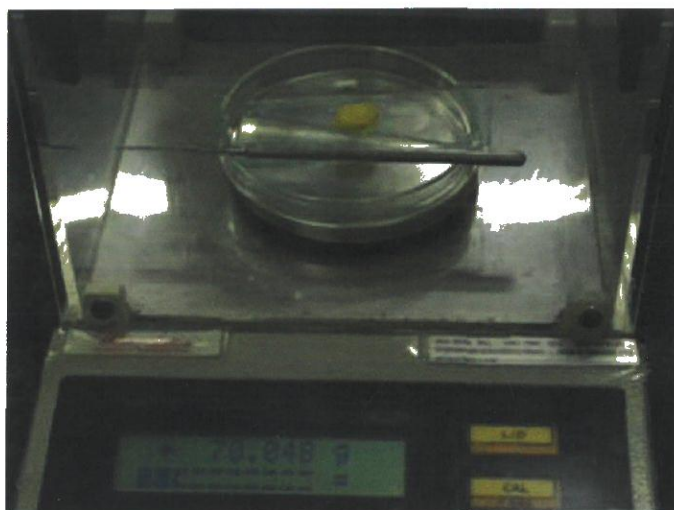
FIGURA 10 – Balança de precisão onde foram aferidos os pesos do iodofórmio e do carbowax da pasta medicamentosa utilizada no trabalho.
