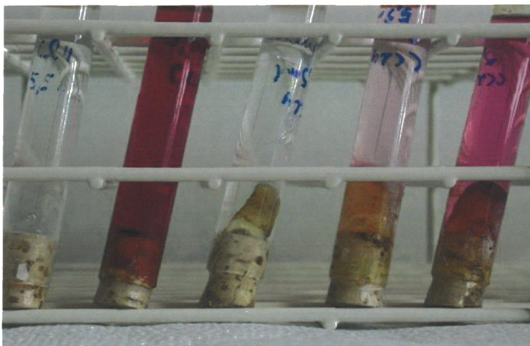
FIGURA 4 – Fotografia dos cinco tubos contendo os fatores utilizados para avaliação e comparação da alteração de coloração do tetracloreto de carbono, realizada 7 dias após o experimento.
