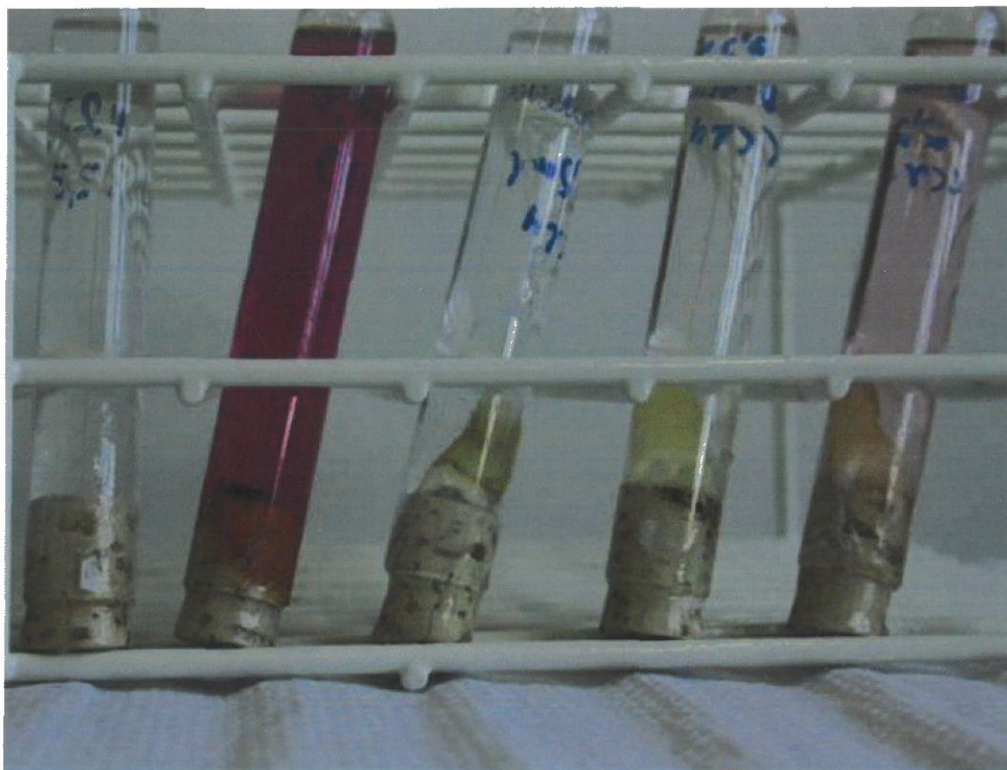
FIGURA 3 – Fotografia dos cinco tubos contendo os fatores utilizados para avaliação e comparação da alteração de coloração do tetracloreto de carbono, realizada 5 dias após o experimento.
