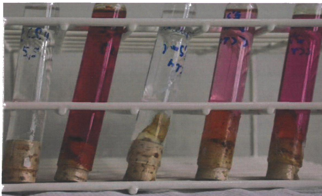
FIGURA 6 – Fotografia dos cinco tubos contendo os fatores utilizados para avaliação e comparação da alteração de coloração do tetracloreto de carbono, realizada 30 dias após o experimento.
