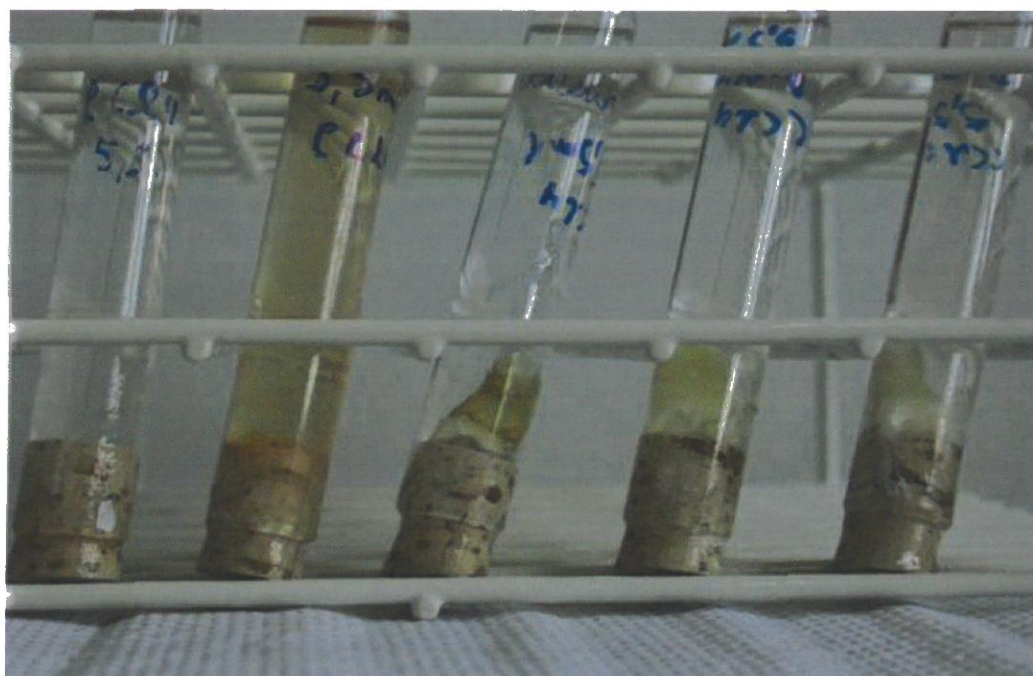
FIGURA 2 – Fotografia dos cinco tubos contendo os fatores utilizados para avaliação e comparação da alteração de coloração do tetracloreto de carbono, realizada 24 horas experimento.
