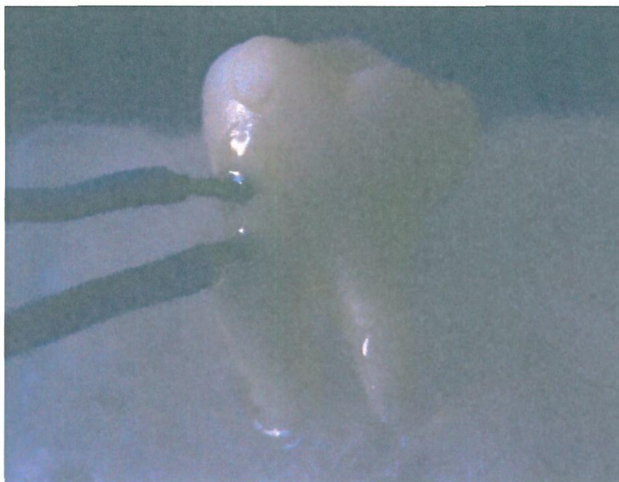
FIGURA 7 – Termopares posicionados nos terços médio e cervical, fixados com cianocrilato
