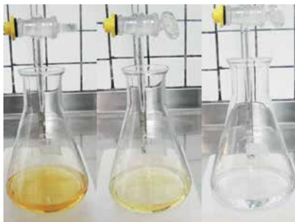
**Figura 2** – Alteração de cor resultante da reação química de titulometria.
